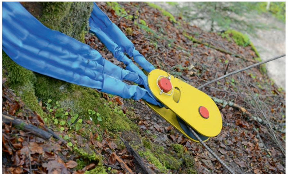
La poulie de renvoi «LT-jaune» est calculée pour des treuils de plus de 8 tonnes de traction. Sa limite de rupture atteint 28 tonnes.
