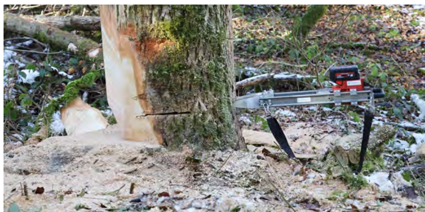
Un coin d'abattage radiocommandé (CARC) installé en position de fonctionnement.
